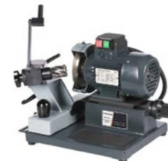
ERM. 100/3 ostrzałka do frezów trepanacyjnych
