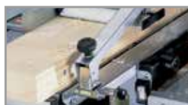
Planing operation Operación de cepillado
