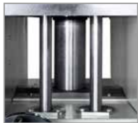
Planner and thicknesser working table mounted on 3 guides in order to avoid the plan rotation Mesa de trabajo montada sobre tres guías de soporte para evitar la rotación del plan
