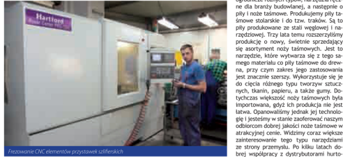
Frezowanie CNC elementów przystawek szlifierek
